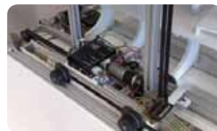
Obr. 2 Konštrukčné riešenie pohybu v horizontálnom smere
