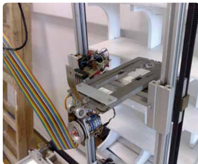
Obr. 3 Konštrukčné riešenie pohybu lyžiny
